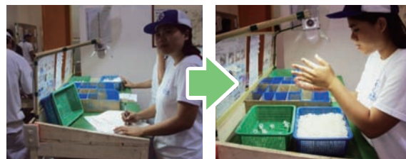
樹脂部品外観検査の作業台にもLED蛍光灯を設置（FPMI）
