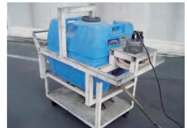
内製による「ろ過精製装置」
