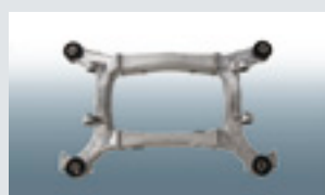
アルミハイブリッド製法による リアサブフレーム
