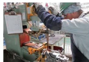
作業者が両手押しのスポット溶接機を使用している様子
