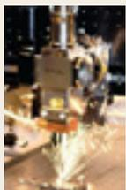
ハイドロ課では、レーザーカットシステムをエネルギー効率の良いモデルに変えました。このレーザーシステムは、電気=光の変換効率が高いため、82%少ない電力(217,300 kWh)で加工できます。
