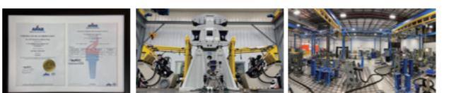
そして2021年の監査にて、サブフレーム・コントロールアームを対象に、油圧加振機を使った耐久・静破壊試験とMTS 329試験機を使った多軸耐久試験において、認証を取得することができました。
