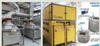
コンプレッサー廃熱による汚泥乾燥化を向上させ、汚泥排出量を約35%削減
